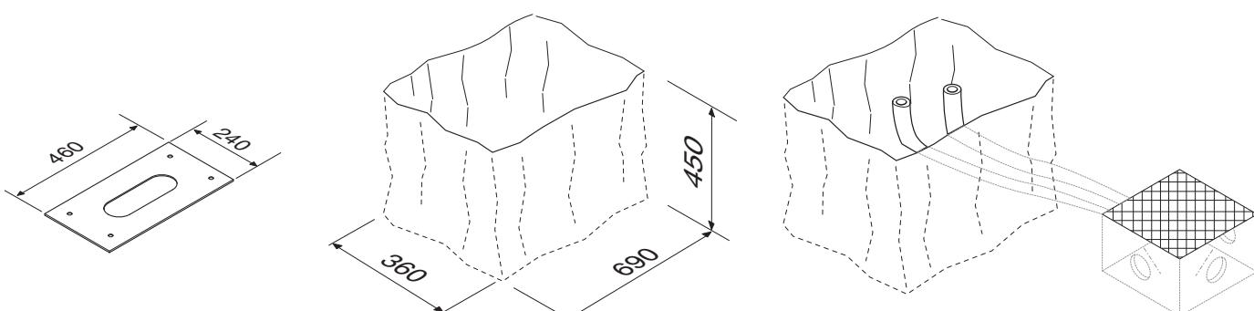
Подготовьте опалубку большего, чем монтажное основание, размера и установите ее в яму. Вставьте железную сетку внутрь опалубки для армирования бетона. Закрепите четыре анкерные пластины на монтажном основании.
