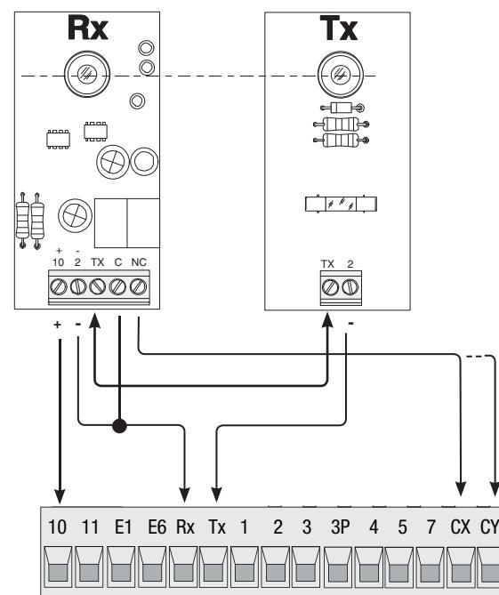
Подключение для работы в синхронном или шлюзовом режиме и для CRP (Came Remote Protocol только для ZL39EX).
