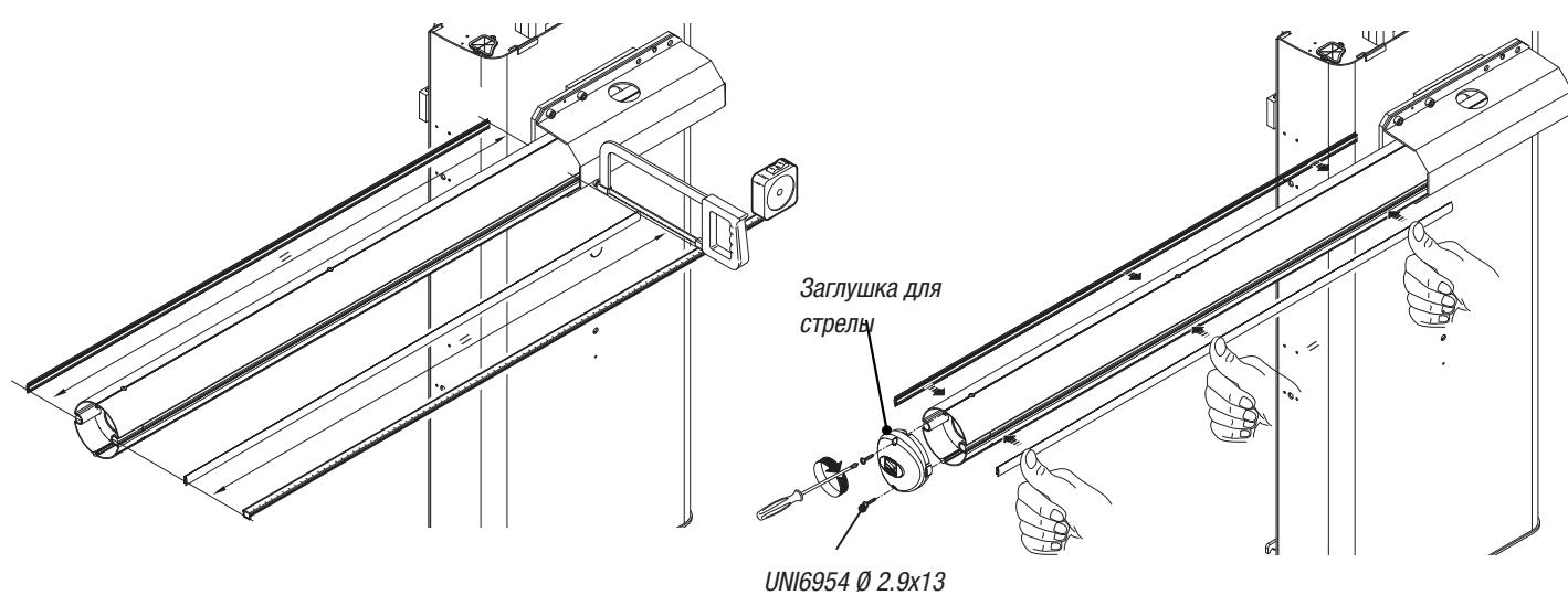
Установите декоративную защитную накладку и зафиксируйте с помощью прилагаемых винтов.
