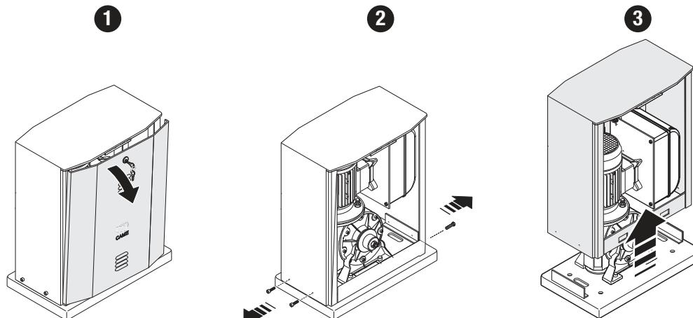
Установите автоматический привод на монтажное основание.
