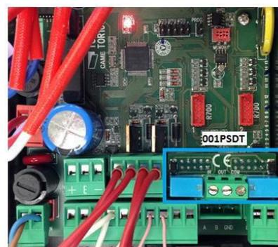
**Twister Light:** для трипедов с блоком **TOR100A** модуль **001PSDT** устанавливается в разъем индикаторов состояния (разрешения прохода), т.к. в этих моделях они не используются.
