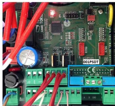
**Twister:** для трипедов с блоком **TOR100** модуль **001PSDT** устанавливается в разъем индикаторов состояния (разрешения прохода) при этом теряется их использование.
