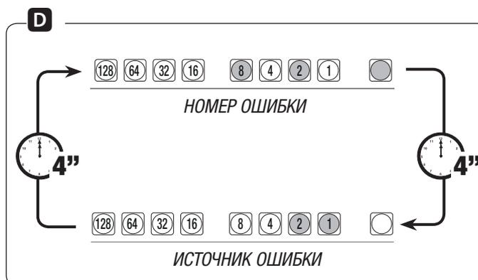
**i** При обнаружении ошибки необходимо выключить и включить турникет повторно спустя 15 секунд или нажать кнопку **RESET** на панели управления для перезагрузки. Турникет выполняет тест (диагностический) и циклы инициализации. Следует учитывать, что сообщение об ошибке в любом случае требует визуальной проверки. При повторном обнаружении ошибки необходимо действовать в соответствии с инструкциями в колонке «**ЧТО ДЕЛАТЬ**» таблицы «**ВИДЫ ОШИБОК**».
