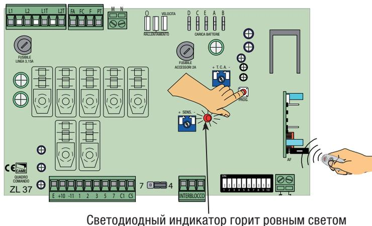
Программирование должно выполняться после перезагрузки электропитания и при опущенной стреле. Запоминание радиокода не происходит, если на плате блока управления горит или мигает светодиод. Если в дальнейшем вы захотите поменять код, достаточно повторить описанную выше процедуру с другим передатчиком.
