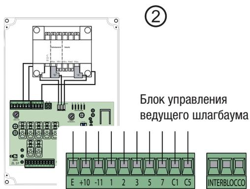
2) Выполните стандартные электрические подключения на блоке управления только ведущего шлагбаума (MASTER).
